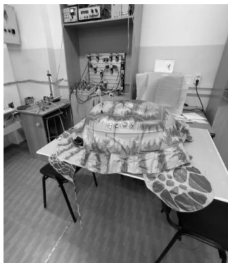
Рис. 2. Опытный образец № 8 Черепашка при замере давления с помощью пневмостенда
