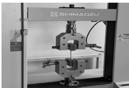
Рис. 1. Образец, закреплённый в верхний и нижний захваты разрывной машины
