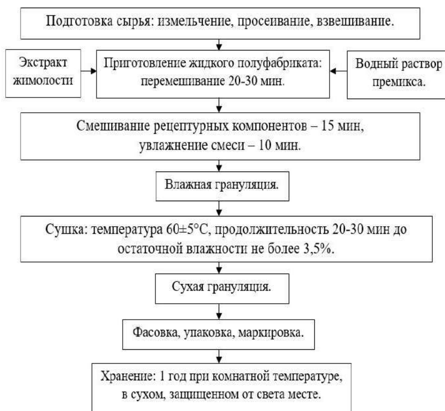
Рис.1 Схема технологического производства сухого витаминизированного напитка с пектином
