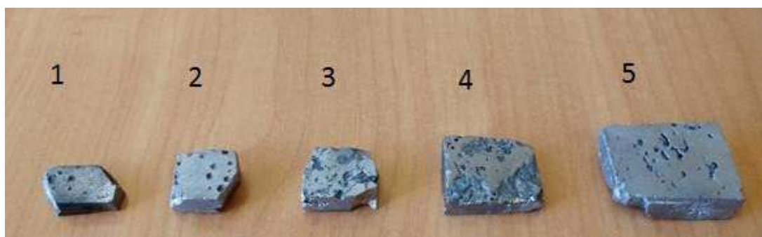
Рис. 1. Исследованные образцы ферросилиция. Результаты исследования приведены в таблице.
